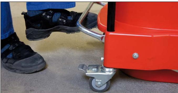
Manejo muy sencillo gracias al vaciado a través de la palanca de pie
